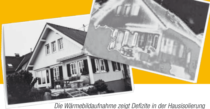
Die Wärmebildaufnahme zeigt Defizite in der Hausisolierung
