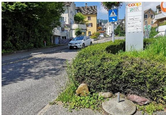
Abbildung 18: Sichteinschränkung aufgrund mehrerer Elemente (Bepflanzung, Kandelaber, Tafel Coop)
