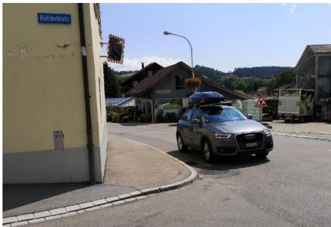
Abbildung 13: Sichteinschränkung aufgrund Gebäude (Einmündung Rütibohlstrasse)
